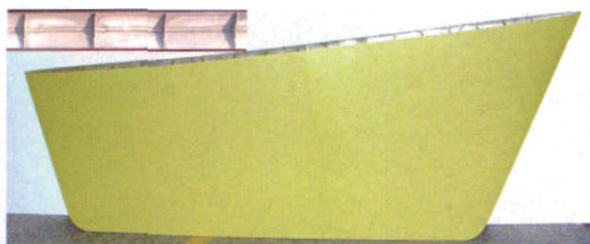
(b) 飞机气动面四层钛合金结构
