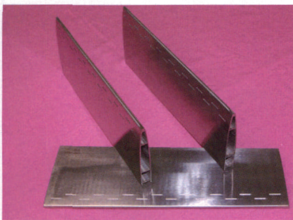
(a) 发动机空心整流叶片
